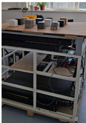
Figura 3.9: Măsurători în laborator ale răspunsului detectorului la muonii atmosferici - matrice formată din nouă cărămizi de 10 \text{ g}/\text{cm}^3 cu densități diferite, plasate deasupra detectorului: 1 - apă, 2 - plumb, 3 - sare, 4 - beton, 5 - aluminiu, 6 - granit, 7 - bucată de pavaj, 8 - oțel, 9 - ferită. Stânga: Aranjamentul cărămizilor deasupra detectorului; Dreapta: Reconstrucția hărții de densitate a obiectelor, după un timp de expunere de 9 zile.
